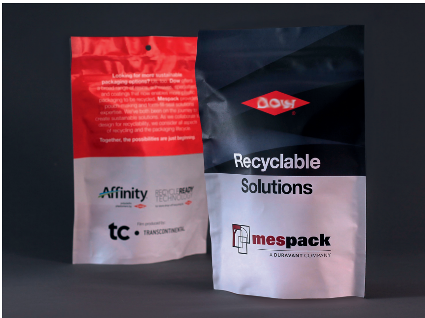
Für die Standbeutel wurden konterbedruckte steife PE-Trägerfolien mit bei niedrigen Temperaturen schweißbaren PE-Folien kaschiert © Mespac
